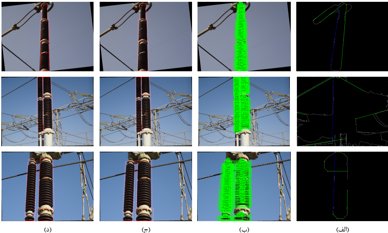
شکل ۵: (الف) اعمال تبدیل هاف به تصاویر و بدست آوردن به ترتیب زوایه های ۱^\circ و ۰/۸^\circ ; (ب) تشخیص محل کلاه های مقره با استفاده از FHOG; (ج) حذف تشخیص های غلط و استخراج محل مقره در تصاویر ب، (د) تشخیص محل کلاه های مقره با استفاده از HOG پایه.
