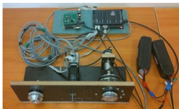
شکل ۳: بستر ساخته شده برای مدل‌سازی سیستم درایو از دو نمای مختلف
